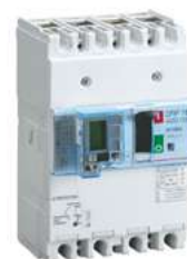
Ejemplo de Interruptor Automático en caja moldeada con módulo diferencial regulable en tiempo de 0 s, 0,3 s, 1 s y 3 s y en sensibilidad de 30 mA, 300 mA, 1 A y 3 A
