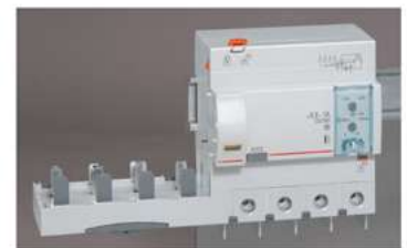
Ejemplo de Bloque diferencial adaptable de carril, regulable en tiempo de 0 s, 0,3 s, 1 s y 3 s y en sensibilidad de 30 mA, 300 mA, 1 A y 3 A
