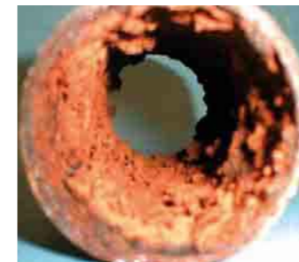
Fig. 1 - Proceso de corrosión
